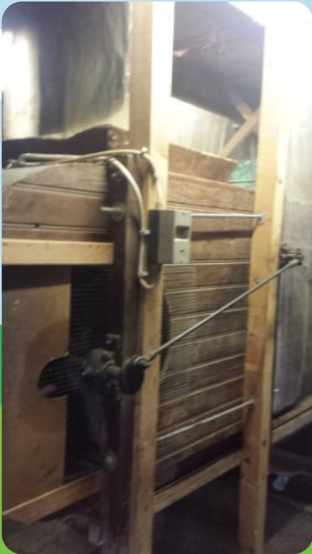
In diese Windfege fallen die Kräuter zur Sortierung
